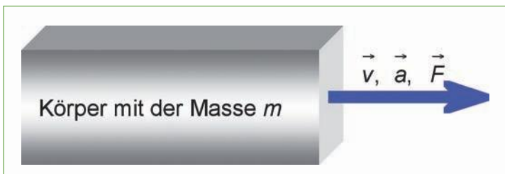
Bild 1: Beschleunigung eines reibungslos gelagerten Körpers
