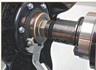
Bild 5: An einer Kupplung installierte Hallensoren erfassen z. B. Lage und Drehzahl
