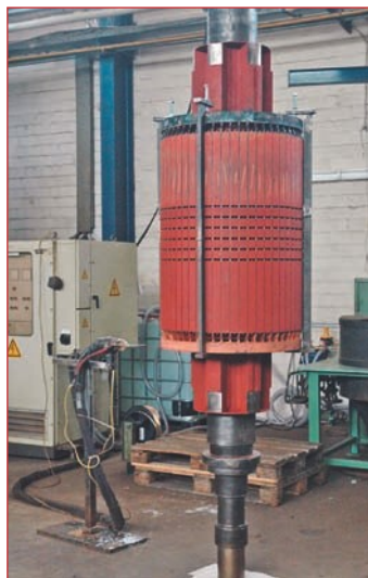
Bild 1: Läufer zum Lötten mittels Mittelfrequenz vorbereitet
