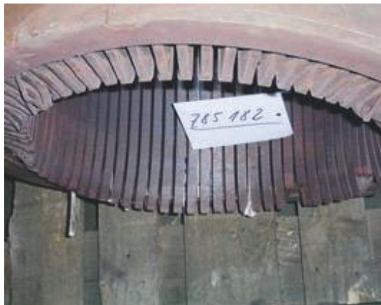
Bild 1: Der mit Pyrolyse behandelte Stator, die Neuwicklung kann beginnen, wenn die Bleche gerichtet wurden
